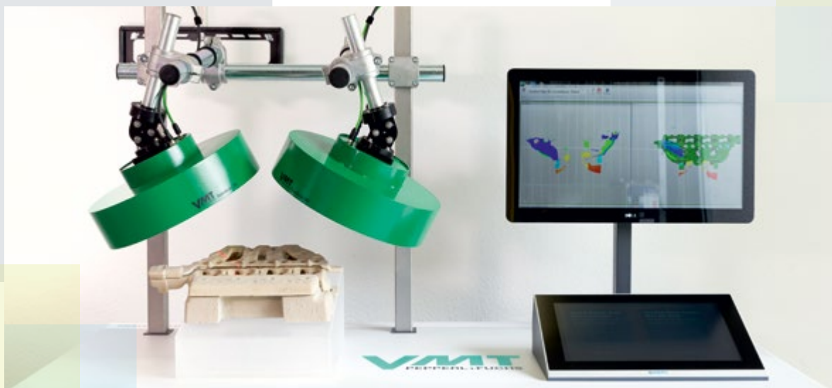
Dans les moindres détails : grâce aux mouvements rotatifs du système SpinScan3D, les quatre détecteurs parfaitement coordonnés produisent une image détaillée du noyau de sable et fournissent ainsi des informations sur le moule de coulée.
